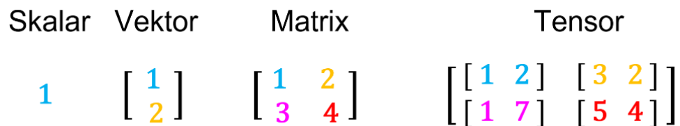
Abb. 5: Darstellung von einem Skalar, Vektor, Matrix und einem Tensor
