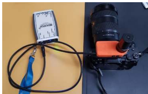
FIGURE 14 – Système d'acquisition choisi, appareil photo reflex et module GNSS RTK.
